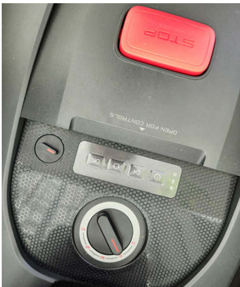
Panel de control en el propio robot. CB
